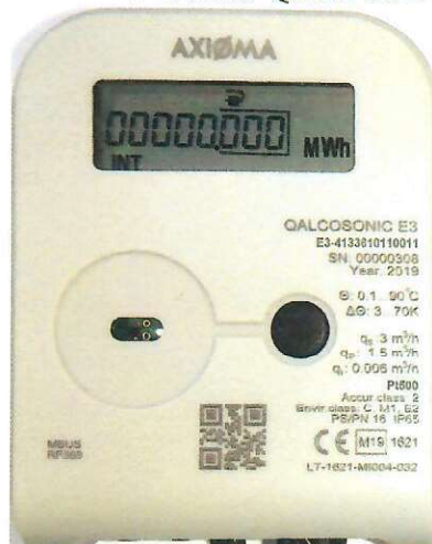
2 pav. Šilumos skaitiklio QALCASONIC E3 skaičiuotuvas
