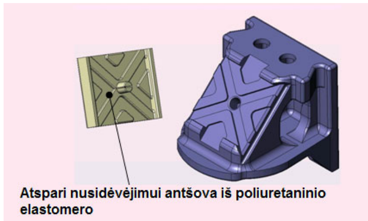
1 – trintinis pleištas; 2 – poliuretaninė tvarslė; 3 – viršlinginė sija
