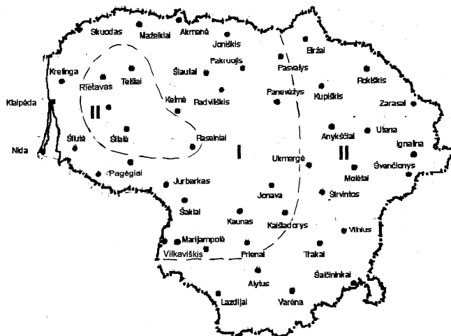
Pav. 3. Lietuvos sniego apkrovos rajonai I - s_k = 1,2 \text{ kN/m}^2 , II - s_k = 1,6 \text{ kN/m}^2 .
