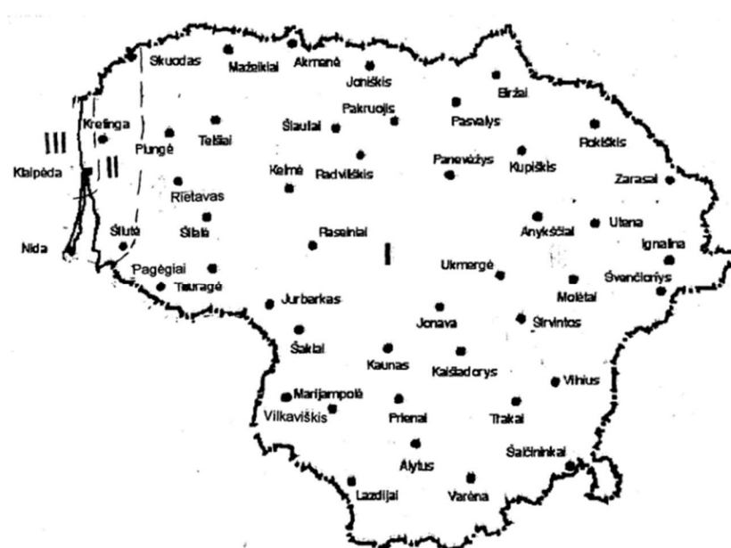
Pav. 2. Lietuvos vėjo apkrovos rajonai I – v_{ref,0}=24 m/s, II – v_{ref,0}=28 m/s, III– v_{ref,0}=32 m/s
