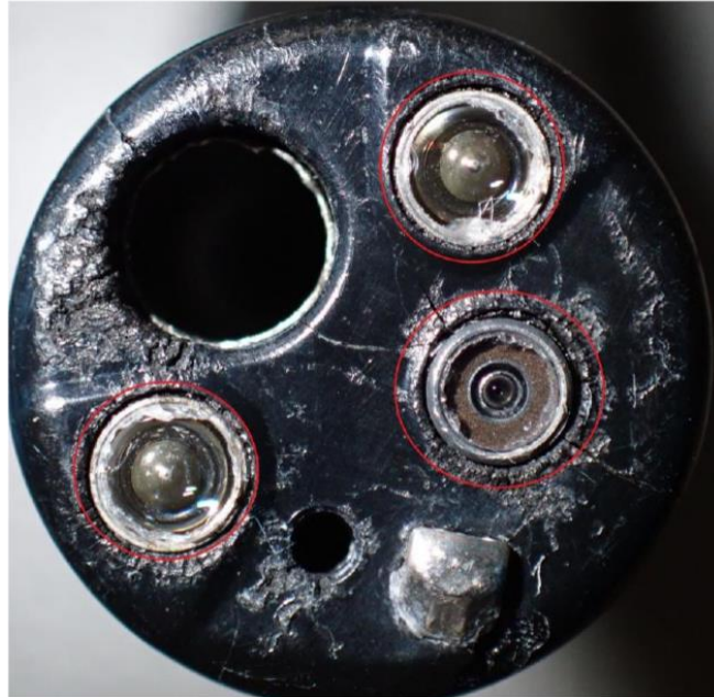
1Pav. Distalinės dalies gaubtelis su apšvietimo ir CCD vaizdo elemento lęšiais.
