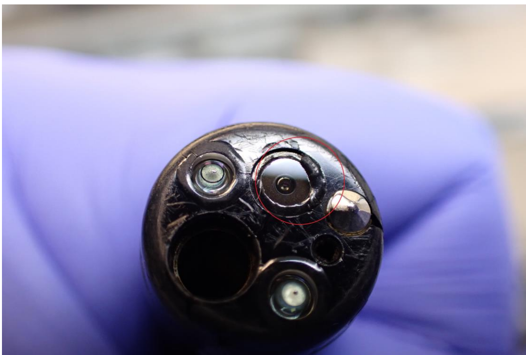
2 pav. Susidėvėjęs CCD vaizdo elemento lęšis
