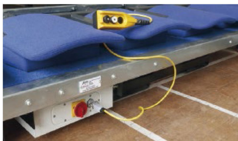
Motorizuota tribūna atidaroma/uždaroma naudojant valdymo pultą prijungiamą po pirmąją platforma.
