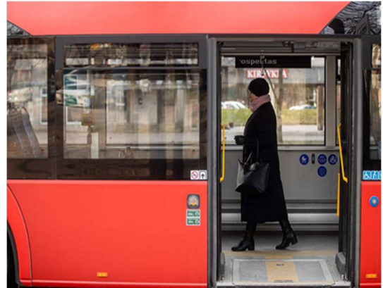
Tinkamai atidarytos keleivių įlipimo/išlipimo durys. Transporto priemonės durys turi atsidaryti sinchroniškai, abi durų varčios kartu.
