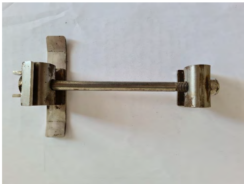
13 pav. Šildymo elemento jungiamasis laikiklis(vaizdas iš viršaus)
