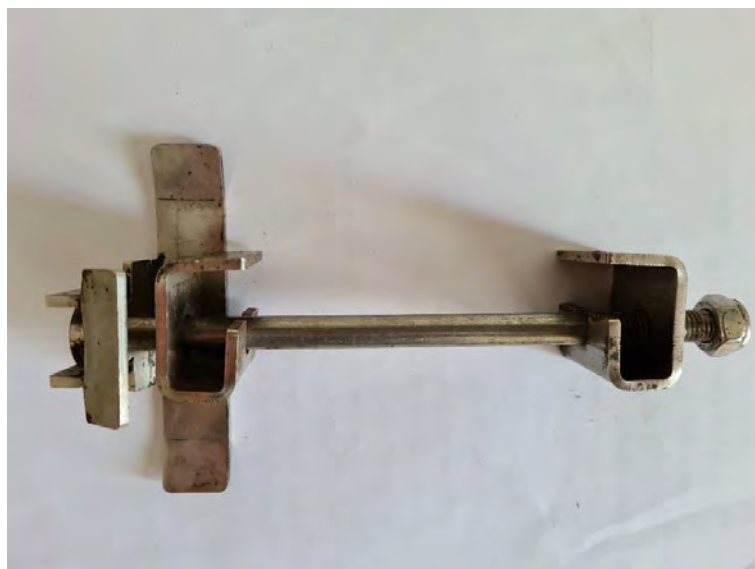
17 pav. Šildymo elemento jungiamasis laikiklis(vaizdas iš šono)
