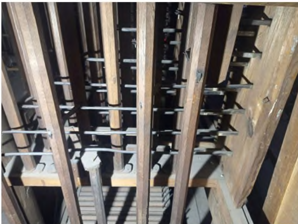
Registų perjungimo rankenos ir mechaninė dalis
