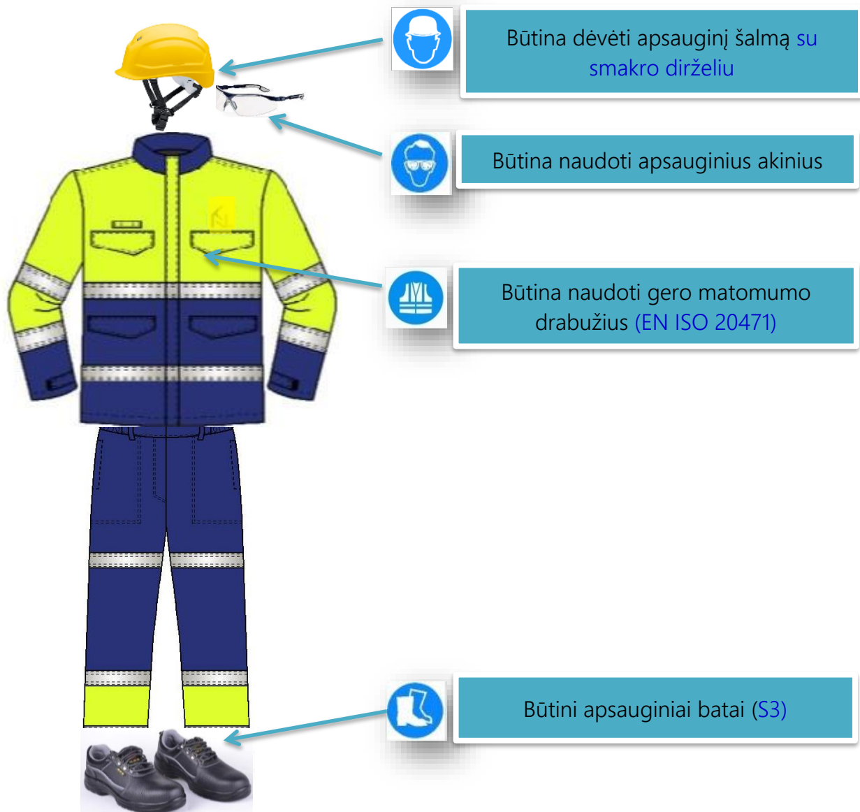
5 pav. Būtinės AAP, patenkančios į KN technologinius objektus ( neįskaitant patekimo į potencialiai sprogia aplinką )
