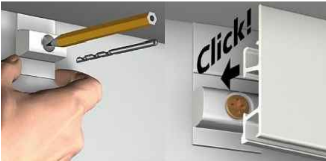
Pakabinimo sistema Click rail montavimo schema (montuojama prie pat esamo karnizo) ir nuoroda į sistemą: https://remai.lt/remai/remeliu-kolekcija-pakabinimo-sistemas-click-rail-ir-combi-rail/79/
