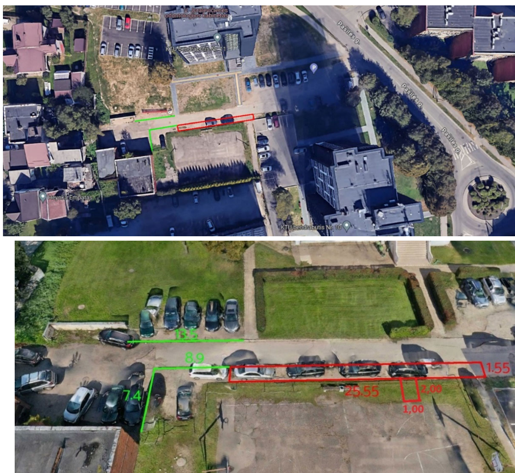
1 pav. šaligatvio ir kelio bortų įrengimo schemas
