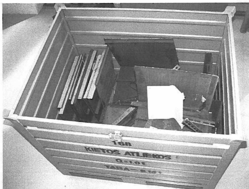
Neteisingai pakrautas konteineris (aukštis)
