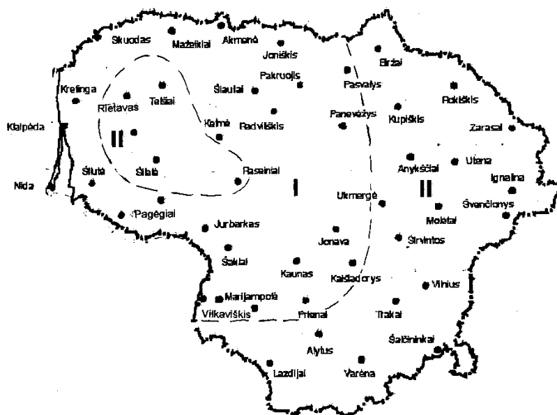
2 pav. Lietuvos sniego apkrovos rajonai I - s_k = 1,2 \text{ kN/m}^2 , II - s_k = 1,6 \text{ kN/m}^2 .
