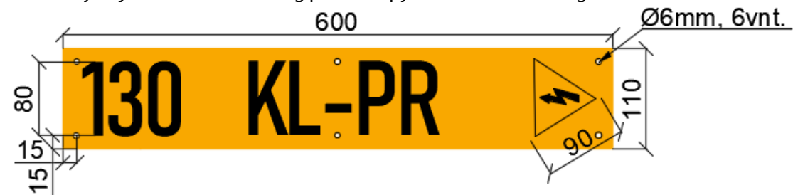
3. 330 kV oro linijos atramos žymėjimo lentelė/ Marking plate for pylons of 330 kV voltage overhead line:
