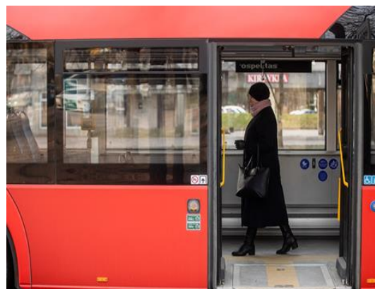
Tinkamai atidarytos keleivių įlipimo/išlipimo durys. Transporto priemonės durys turi atsidaryti sinchroniškai, abi durų varčios kartu.
