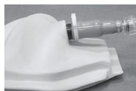
照片 7 安装夹具并压紧。
