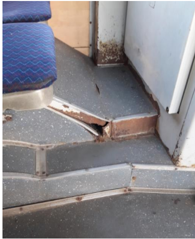
Transporto priemonės salono elementai paveikti korozijos, netvarkingi, blogos estetinės būklės.
