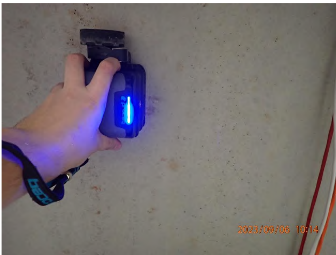
Nuotrauka Nr. 6. Denginio plokščių armavimo nustatymas
