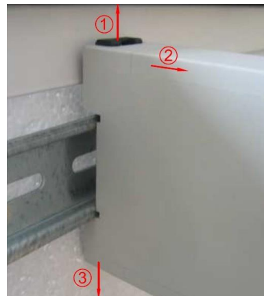
Pav. 3-2 Montavimo (a) bei nuėmimo (b) nuo DIN bėgelio instrukcija
