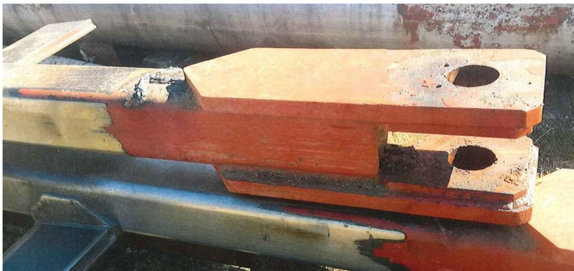
4 pav. Biokuro sandėlio žertuvo mazgas prijungimui prie hidrocilindro
