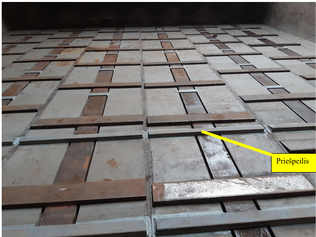
4 pav. Biokuro sandėlio žertuvo mazgas prijungimui prie hidrocilindro
