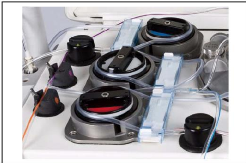
5-10 pav.: MCS+ pompos vamzdelio automatinio įkėlimo paruošimas
