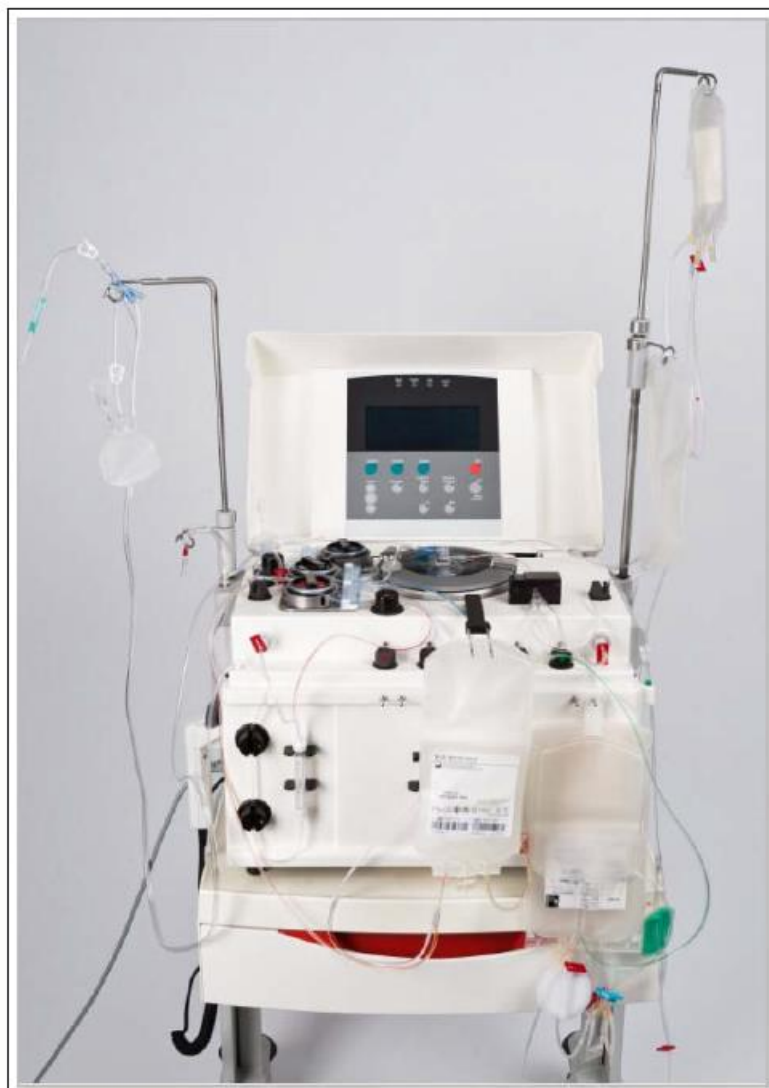
4-10 pav.: Pilnai instaliuotas 949FF-E vienkartinis rinkinys
