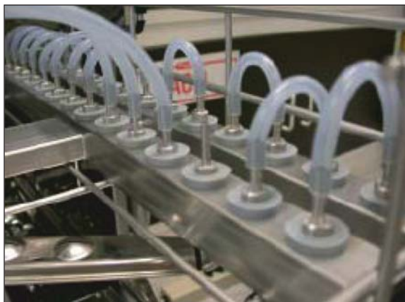
4-3 pav. Automatinis plovimas: užkimšti nenaudojami inžektoriai Paveiksluose vaizduojamas įrenginys: „Miele® Labwasher“, modelis G7735, su modelio Nr. 0-177 inžektoriumi
