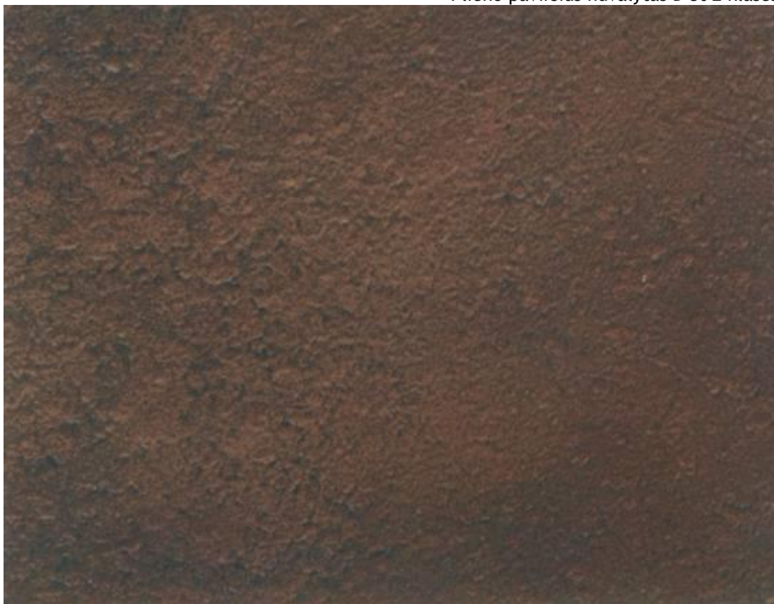
Plieno paviršius nuvalytas D St 3 klasės
