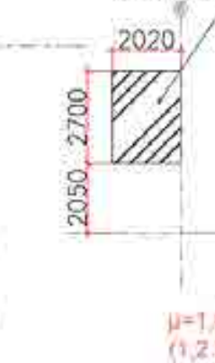
Lifto šachtos perdangų 1-3 aukštų apkrovų schema
