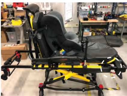
Kuva 30 – Kiinnitys jalkopään jatkoputkeen
