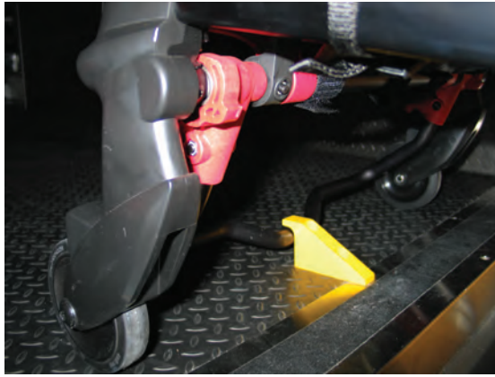
Kuva 7 – Turvatanko kiinnitetty ajoneuvon turvakoukkuun
