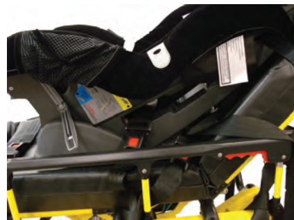
Ábra 29 – Rögzítse a derékbekötőt
