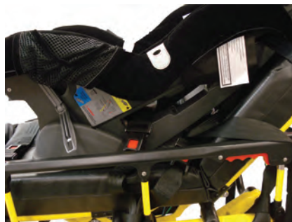
Figura 29 – Fije la sujeción de la cintura
