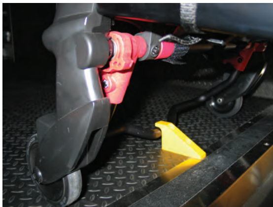
Figur 7 – Säkerhetsstängens kopplas till fordonets säkerhetskrok
