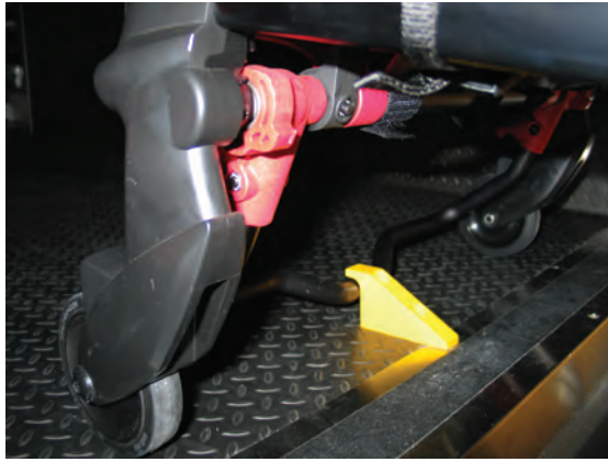
그림 7 – 안전바가 차량 안전 후크에 고정되어 있는 상태
