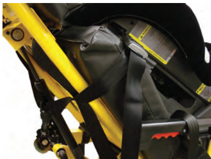
Figura 28 – Ubicación de la correa de anclaje
