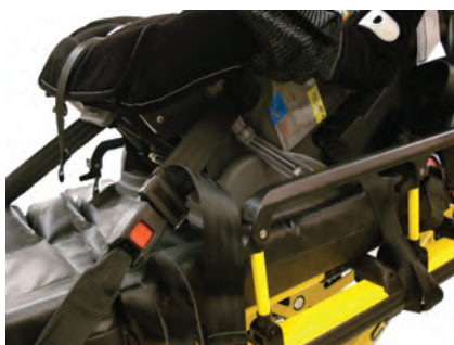
Figura 31 – Posizione del sistema di contenimento
