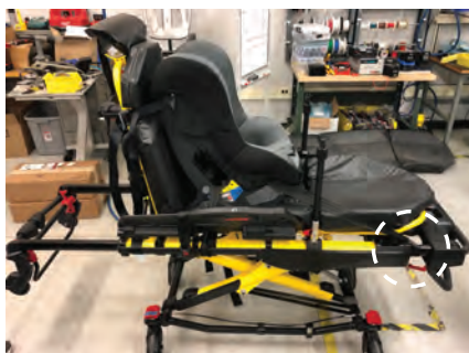
Figur 30 – Sätt fast på fotändens förlängningsrör
