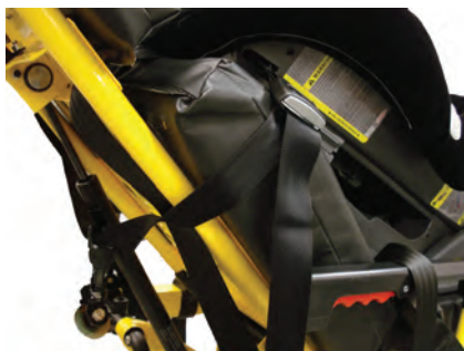
Figura 28 – Locația curelei de ancorare
