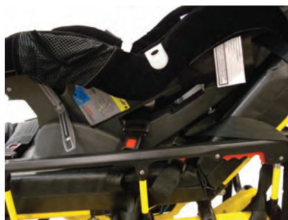
Rysunek 29 – Mocowanie pasa unieruchamiającego zakładanego na poziomie talii
