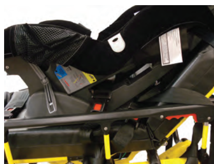
Figura 29 – Fissare la cinghia di contenimento per la vita
