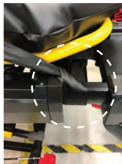
Joonis 30 – Kinnitage jalutsi pikendustoru
