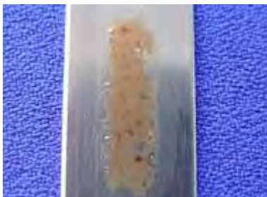
Blogas plovimo rezultatas: likučiai ant metalinės plokštelės
