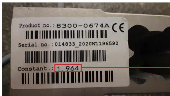
50 pav. 1 jutklio pastovi vertė, atspausdinta ant jutklio gaminio / serijos etiketės
