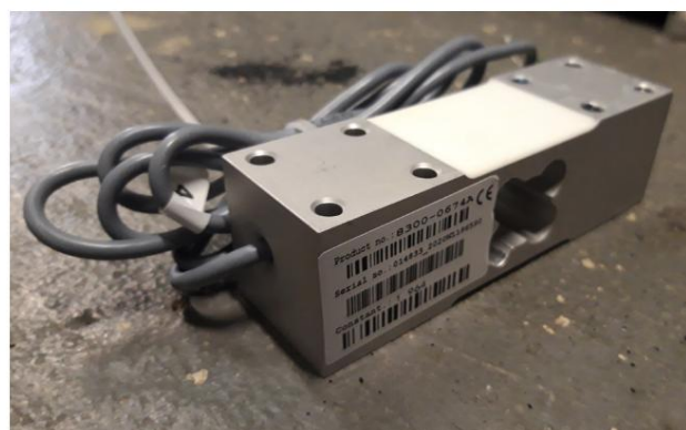
50 pav. 1 jutklio pastovi vertė, atspausdinta ant jutklio gaminio / serijos etiketės
