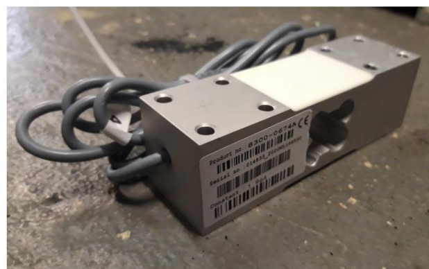
52 pav. 3 jutiklio pastovi vertė, atspausdinta ant jutiklio gaminio / serijos etiketės
