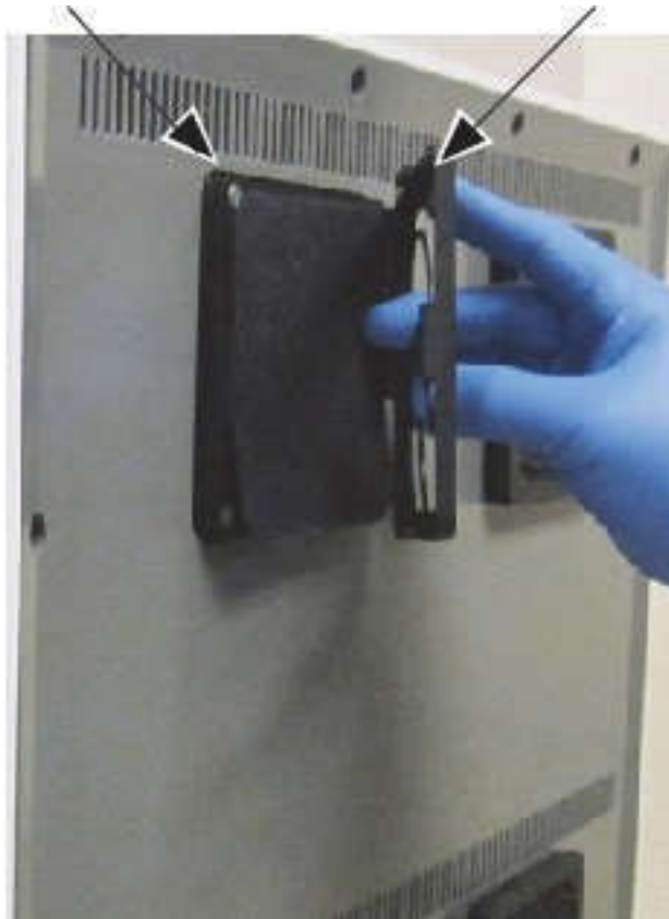
Pav. 9-15. Ventiliatoriaus filtro apsauginių grotelių ir filtro nuėmimas
