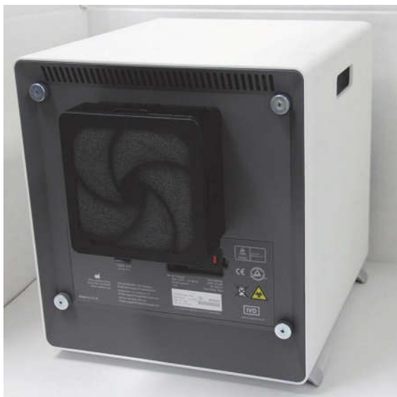
Pav. 9-17. GeneXpert GX-IV instrumentas pasuktas taip, kad filtras galėtų būti laisvai pasiekiamas
