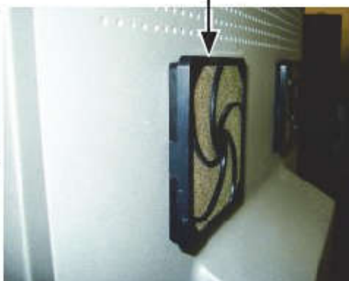
Pav. 9-13. Filtro keitimas ir įstatytos apsauginės filtro grotelės
