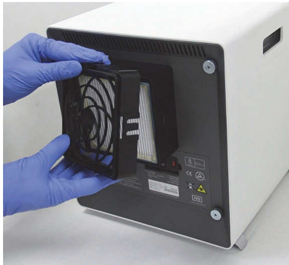
Pav. 9-20. HE filtro laikiklio išėmimas
