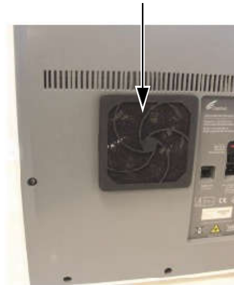
Pav. 9-16. Filtro keitimas ir apsauginės filtro grotelės
