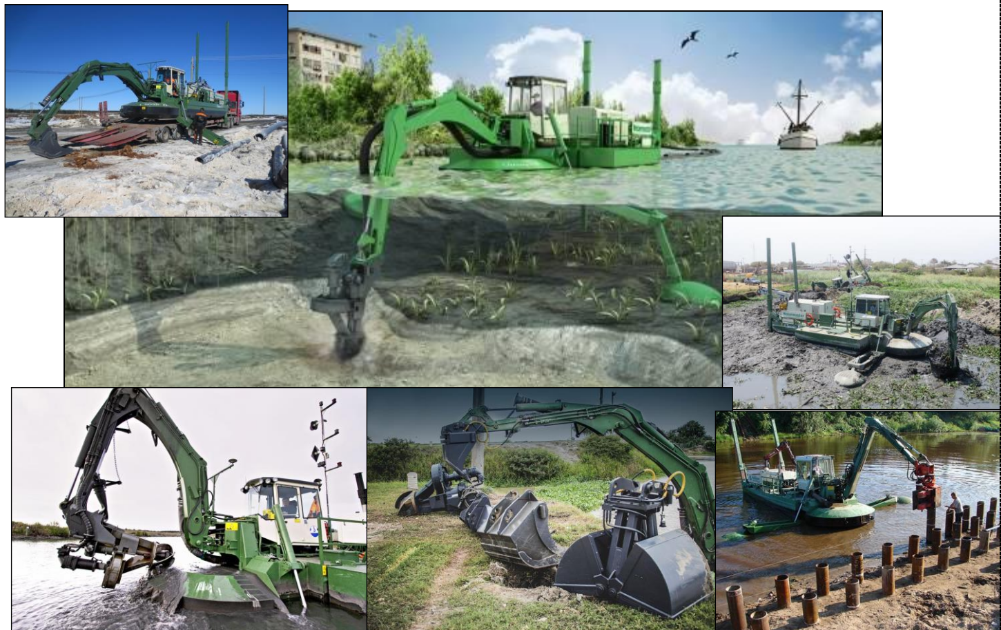
Pav. 8. Universali žemsiurbė Watermaster Classic III (IV) (Gamintojo nuotraukos iš www.watermaster.fi )
