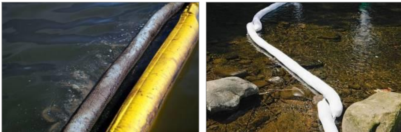
Pav. 11. Naftos produktus sugeriančios sorbento „rankovės“ (nuotr. iš www.texasboom.com )
