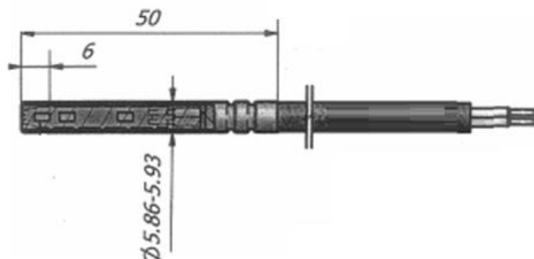
B3.2 pav. PL tipo temperatūros jutiklio gabaritiniai matmenys
