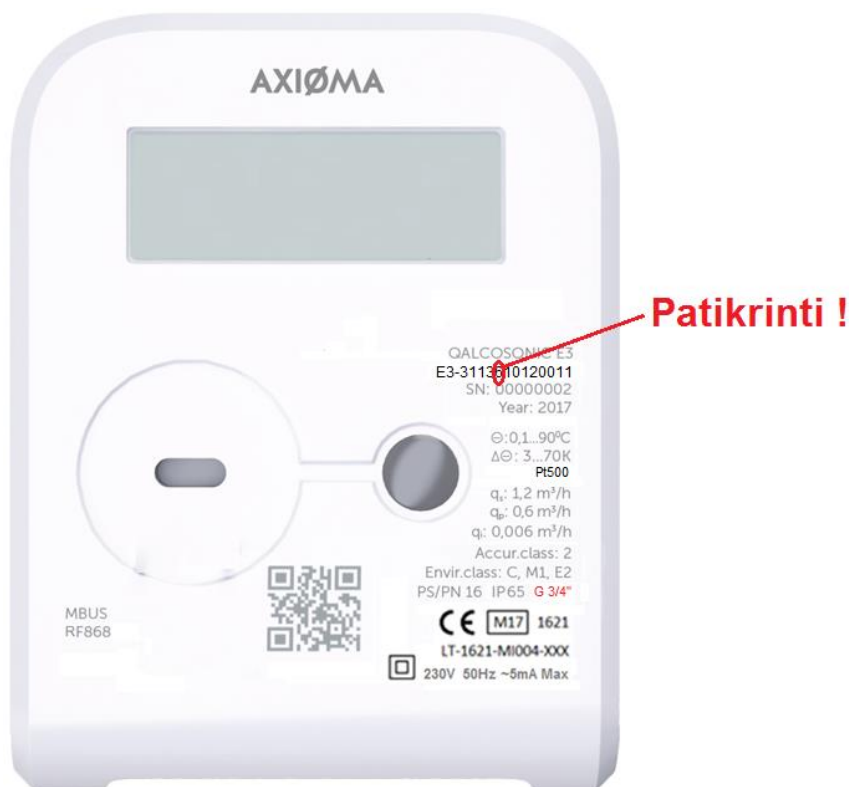
a) Patikrinti ar skaitiklio konstrukcinis variantas yra su keičiamais temperatūros jutikliais
