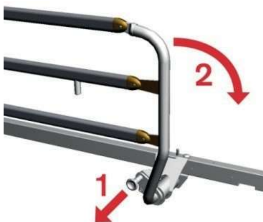
pav. Iš apačios valdomų ištininių sudedamųjų šoninių turėklų atleidimo mechanizmas
