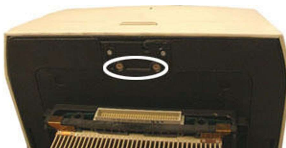
86 iliustracija. Norėdami atrakinti optinio modulio užraktą, atsukite šiuos varžtus.
