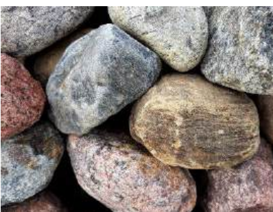
Pav. 18. Gabionų užpildymui naudojami granito rieduliai
