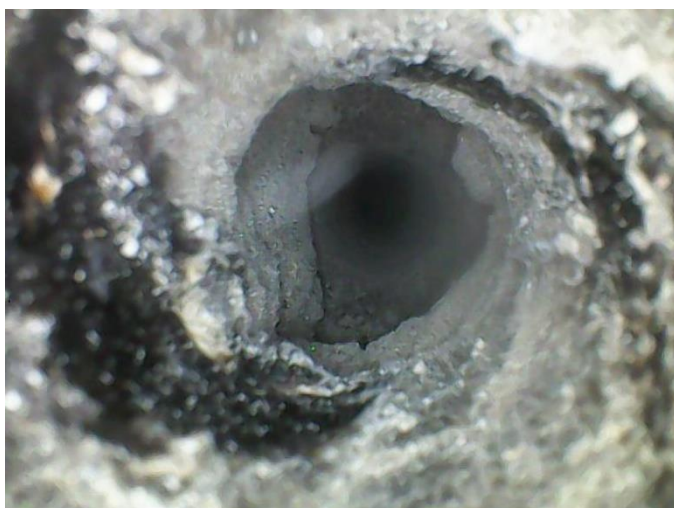
26 pav. Denginio sluoksnių tyrimas endoskopu, matomas cementinio skiedinio ir hidroizoliacijos sluoksniai.
