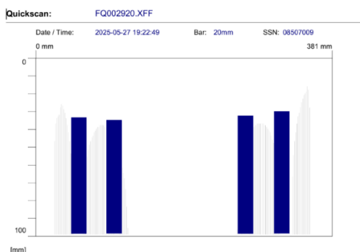
29 paveikslas. Pirmojo aukšto rėmo gelžbetoninės konstrukcijos skenavimo duomenys
