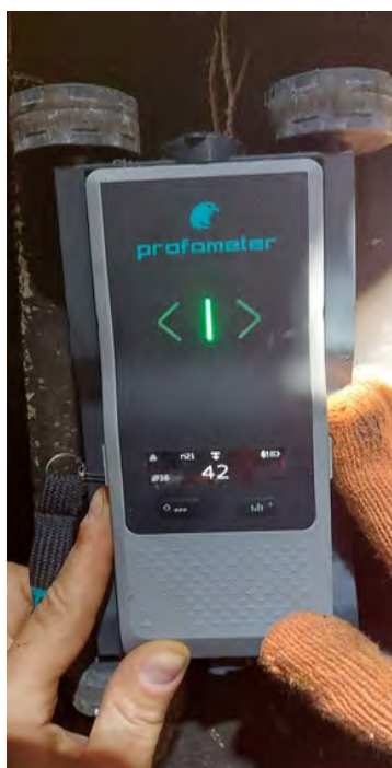
Pav. 8.6 Armatūros apsauginio sluoksnio matavimas
