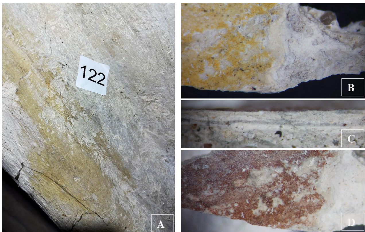
34 pav. Mėginys P22 – Zn-122 (tapyto angelo plaukai): A – paėmimo vieta; B – vaizdas pro mikroskopą, x20; C – mėginio skerspjūvio vaizdas pro mikroskopą, x40; D – mėginio, iškaitinto 600 °C temperatūroje, vaizdas pro mikroskopą, x20
