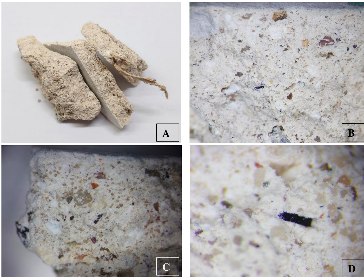
2 pav. Mėginys Nr.1 – T1 (sienos tinkas): A – bendras mėginio vaizdas; B – mėginio vaizdas pro mikroskopą, x40; C – mėginio vaizdas pro mikroskopą, x20; D – mėginio vaizdas (matomas medžio anglies gabaliukas) pro mikroskopą, x60
