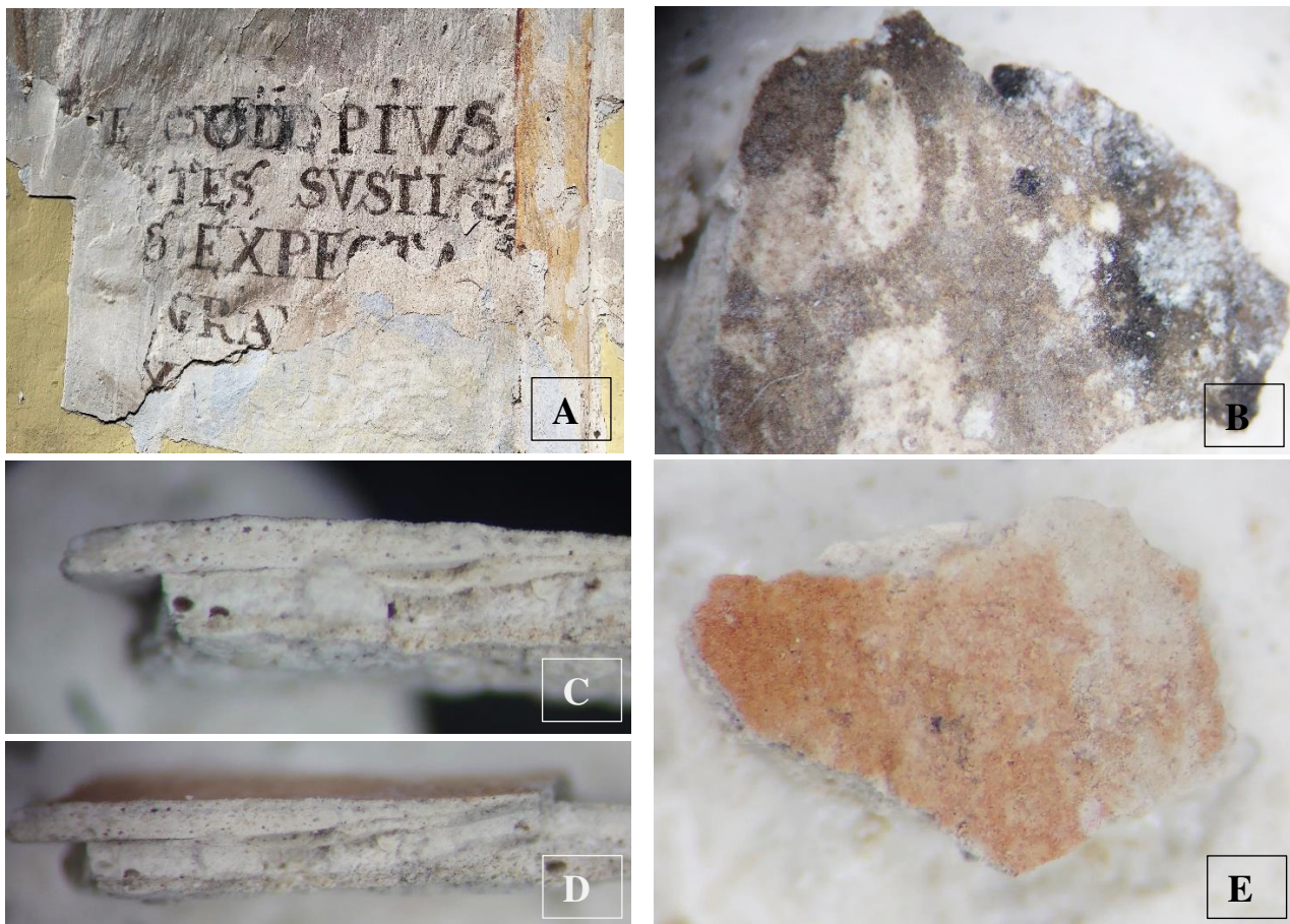
10 pav. Mėginys P-3 – „Traidė“: A – paėmimo vieta; B – mėginio vaizdas pro mikroskopą, x20; C – mėginio, skerspjūvio vaizdas pro mikroskopą, x 40; D – mėginio, iškaitinto 600 °C temperatūroje, skerspjūvio vaizdas pro mikroskopą, x 40; E – mėginio, iškaitinto 600 °C temperatūroje, vaizdas pro mikroskopą, x20.
