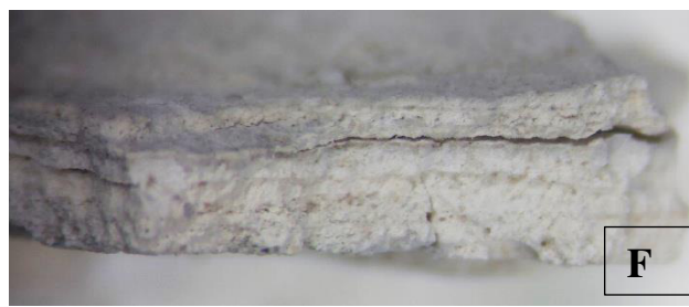
9 pav. Mėginys P-2 (angokraštis – šviesiai ir tamsiai pilka spalvos): A – paėmimo vieta; B – tamsiai pilkos spalvos mėginio vaizdas pro mikroskopą, x20; C – šviesiai pilkos spalvos mėginio vaizdas pro mikroskopą, x20; D – tamsiai pilkos spalvos mėginio, iškaitinto 600 °C temperatūroje, vaizdas pro mikroskopą, x20; E – tamsiai pilkos spalvos mėginio skerspjūvio vaizdas pro mikroskopą, x40; F – tamsiai pilkos spalvos mėginio, iškaitinto 600 °C temperatūroje, skerspjūvio vaizdas pro mikroskopą, x40;
