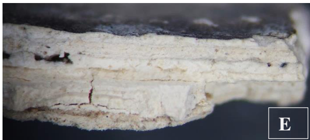
9 pav. Mėginys P-2 (angokraštis – šviesiai ir tamsiai pilka spalvos): A – paėmimo vieta; B – tamsiai pilkos spalvos mėginio vaizdas pro mikroskopą, x20; C – šviesiai pilkos spalvos mėginio vaizdas pro mikroskopą, x20; D – tamsiai pilkos spalvos mėginio, iškaitinto 600 °C temperatūroje, vaizdas pro mikroskopą, x20; E – tamsiai pilkos spalvos mėginio skerspjūvio vaizdas pro mikroskopą, x40; F – tamsiai pilkos spalvos mėginio, iškaitinto 600 °C temperatūroje, skerspjūvio vaizdas pro mikroskopą, x40;
