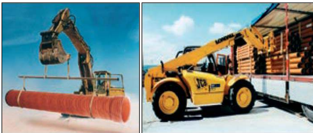
4 paveikslas. Mechanizuotas vamzdžių krovimas
