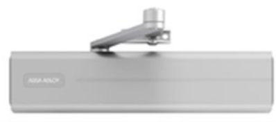
ABLOY DC340+L190 (arba lygiavertis) Durų pritraukiklis su standartine trauke. Vidaus ir lauko durims, priešgaisrinėms durims iki 120 kg. Su „back-check“ funkcija. Sertifikuotas 500.000 darbo ciklų, reguliuojama uždarymo jėga uždarymo jėga EN 2-6, temperatūrinis režimas -35°C...+45°C. Neatsijungianti traukė. CE ženklavimas.
