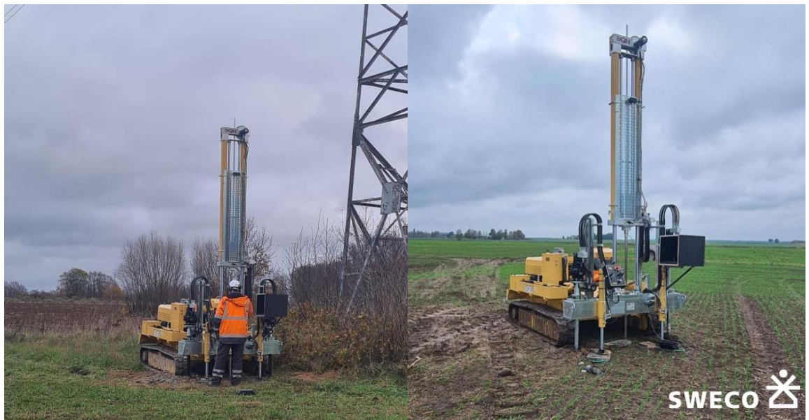
1 Pav. Statinio zondavimo bandymai atlikti agregatu „Pagani TG 73 – 200 kN“
