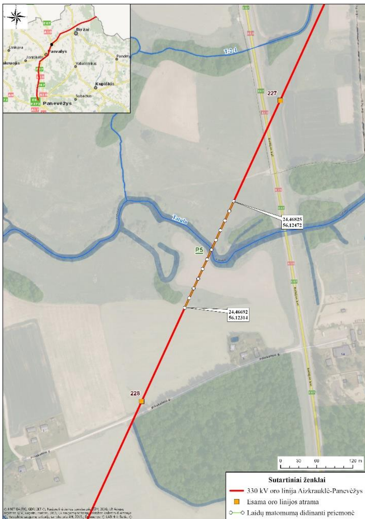
6. Pav. Rekonstruojamos 330 kV OL Aizkrauklė-Panevėžys atkarpos, kuriose numatomas laidų vizualumo didinimas ties Pamūšiais (P5), rekonstruojamos atramos Nr. 227-228.
