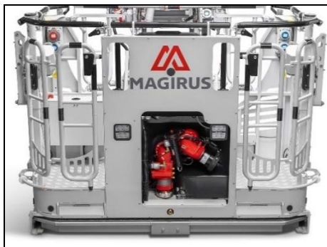
„RC500“ su priekyje integruotu vandens stebėjimo prietaisu
