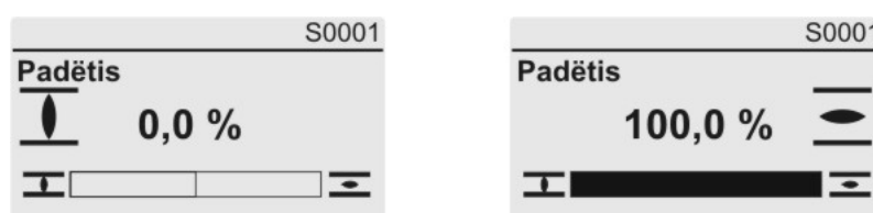
Pav. 35: Pasiekta galinė padėtis UŽD./ATID.
