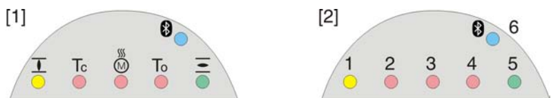
Pav. 50: Signalinių lempučių išdėstymas ir reikšmė
