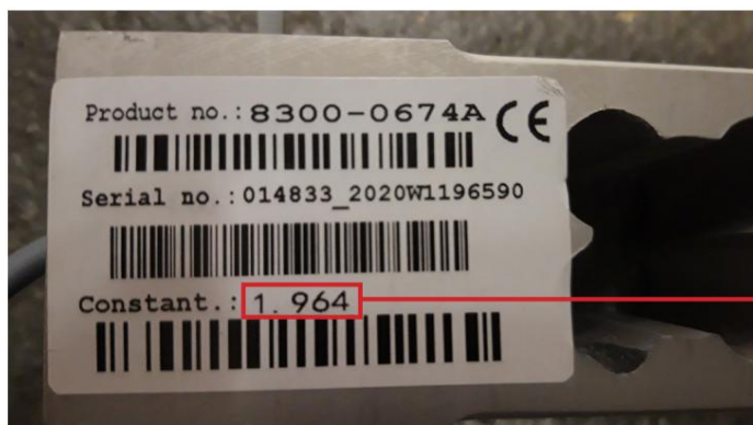
53 pav. 4 jutiklio pastovi vertė, atspausdinta ant jutiklio gaminio / serijos etiketės
