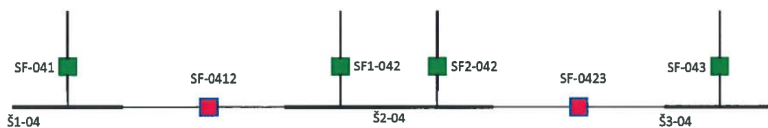
2 pav. Trijų ir daugiau savųjų reikmių 0,4 kV šynų sekcijų komutacinių aparatų operatyvinių pavadinimų pavyzdys
