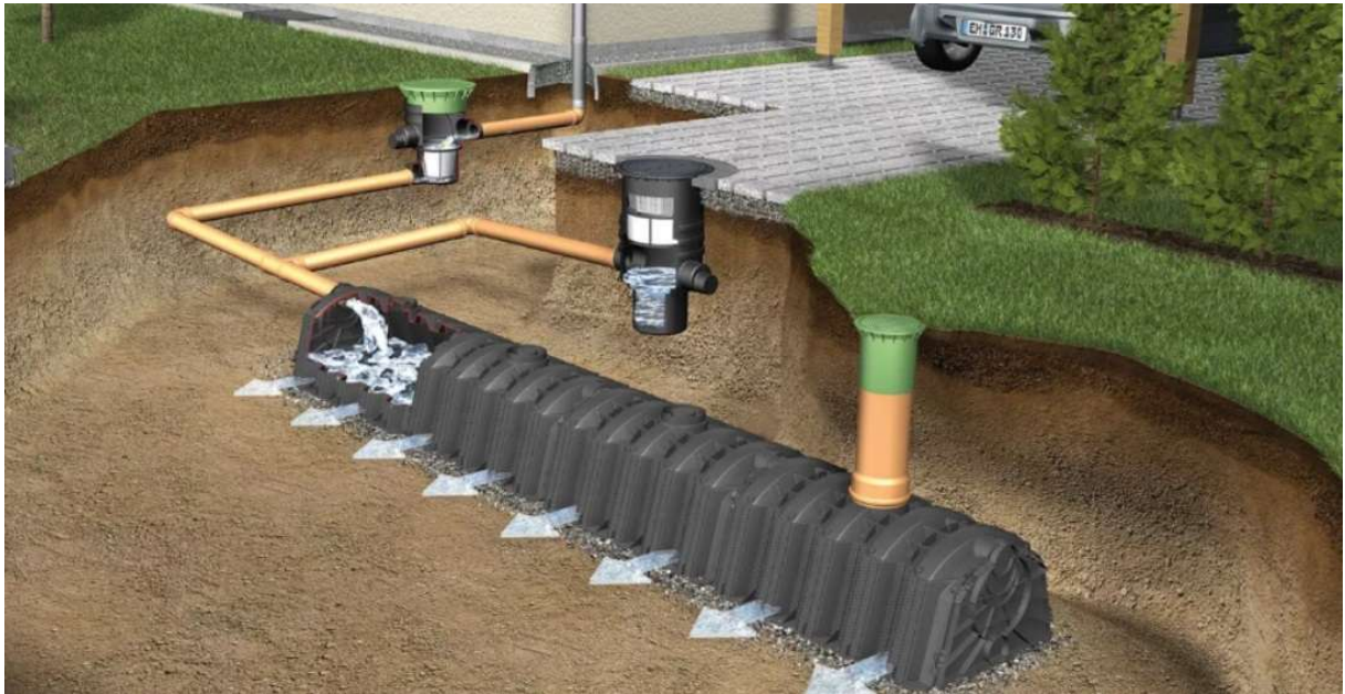
Pav. 1. Schema kaip galėtų būti surenkamas lietaus vanduo.
