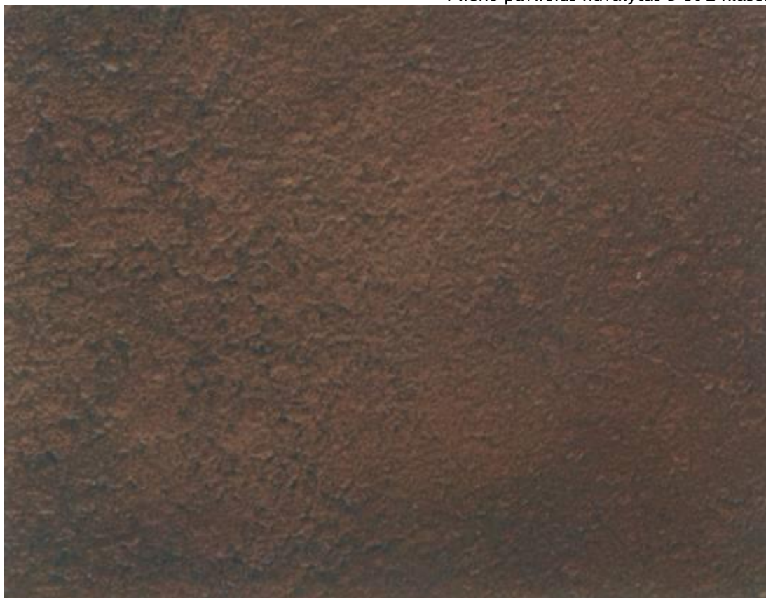
Plieno paviršius nuvalytas D St 3 klasės
