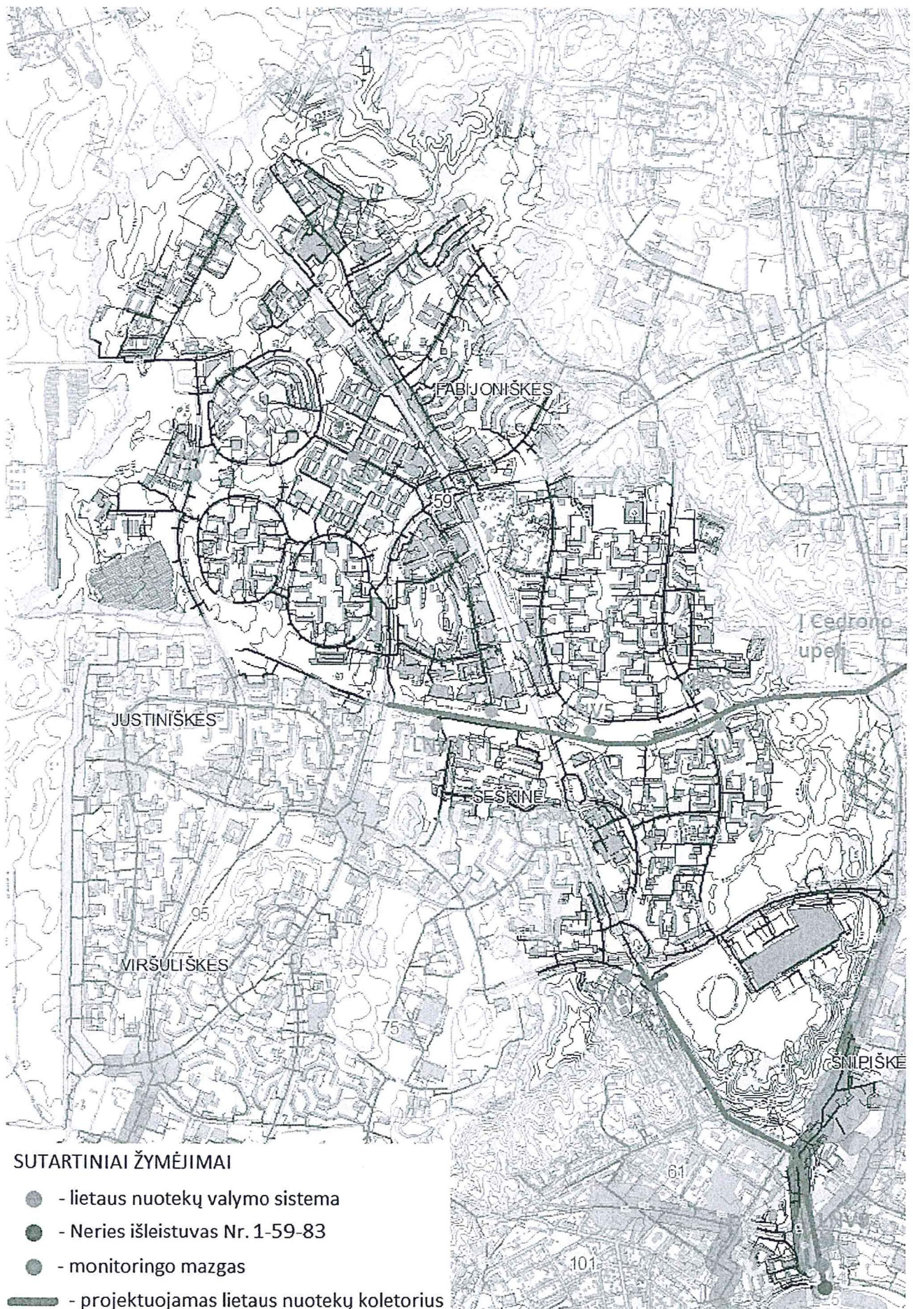
3 pav. Vilniaus miesto teritorijoje esančio paviršinių lietaus nuotekų surinkimo baseino Nr. 59 ir jame projektuojamų elementų situacijos schema (3 variantas)
