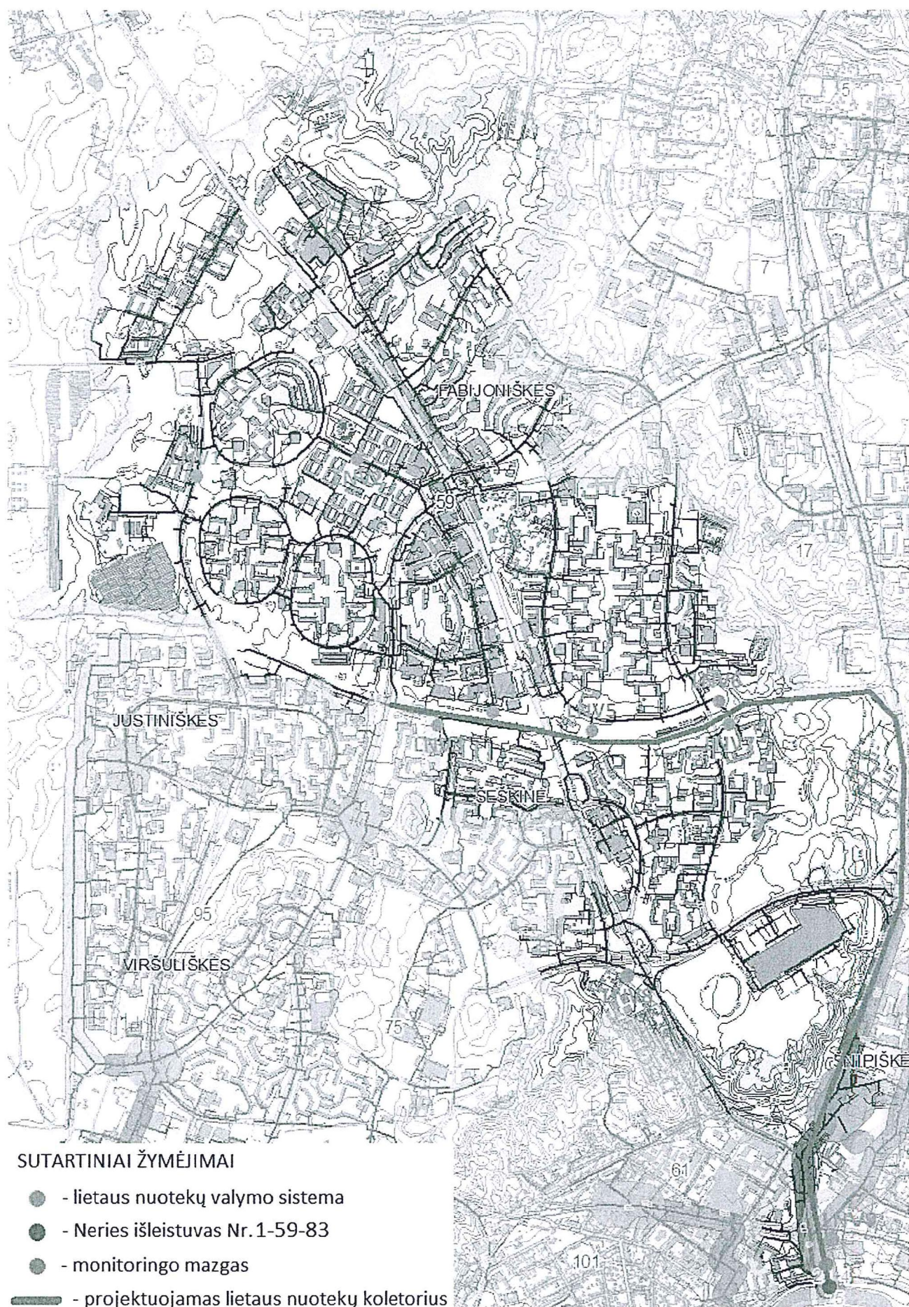
2 pav. Vilniaus miesto teritorijoje esančio paviršinių lietaus nuotekų surinkimo baseino Nr. 59 ir jame projektuojamų elementų situacijos schema (2 variantas)
