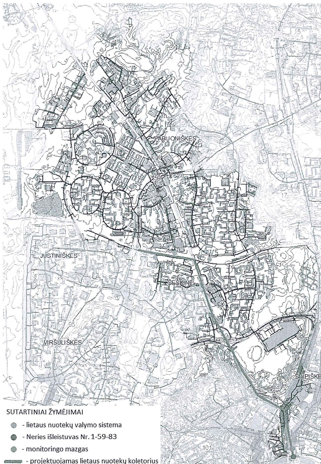
1 pav. Vilniaus miesto teritorijoje esančio paviršinių lietaus nuotekų surinkimo baseino Nr. 59 ir jame projektuojamų elementų situacijos schema (1 variantas)
